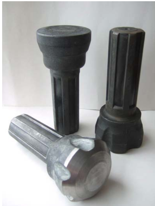
图 3 多次复合冷锻精密成形件工艺制造的 CIR90-90 潜孔钻头毛坯
