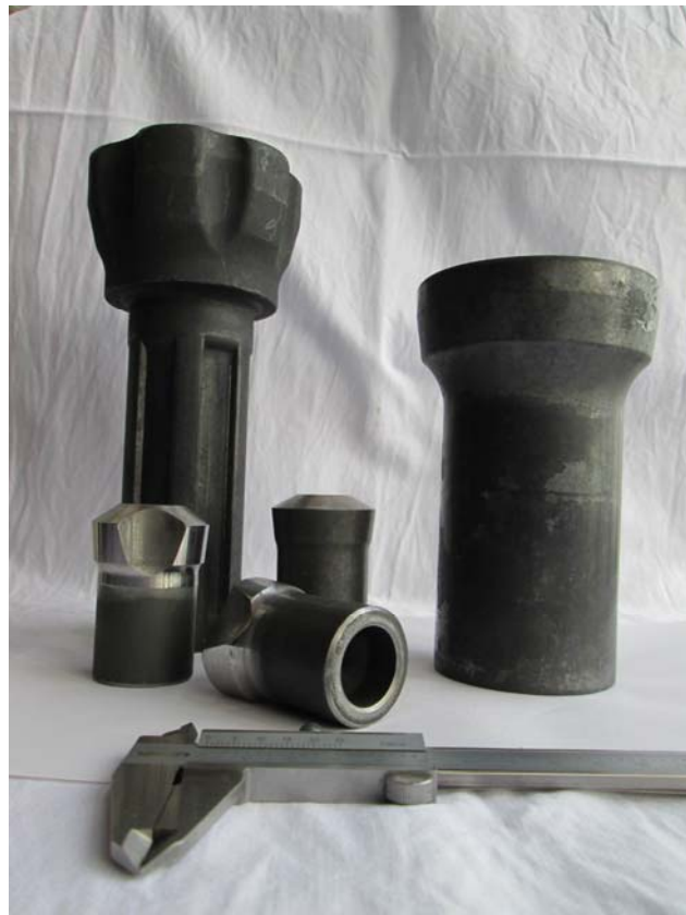
(a) 冷锻精密成形技术制造的钎头、钎具
