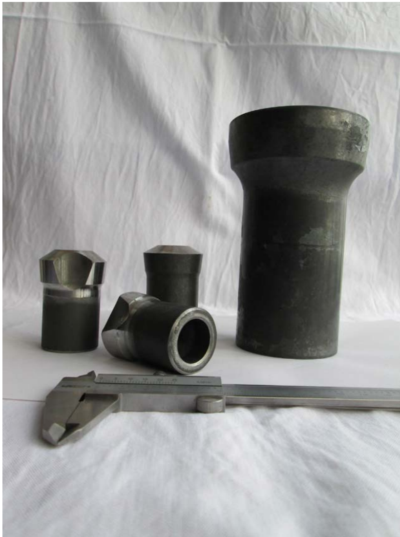
图 14 多向复合挤压件与成形钎具
