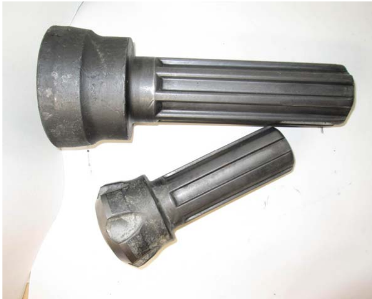
> 图 13 大高径比锻挤精密成形件
