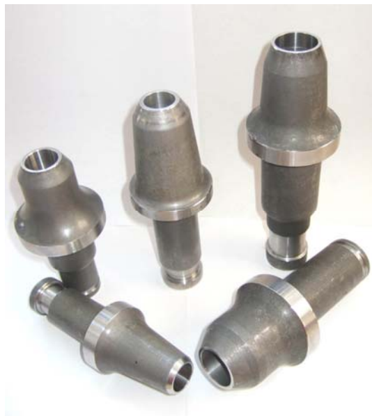
图 1 公司为山特维克生产的冷锻精密成形截齿毛坯
